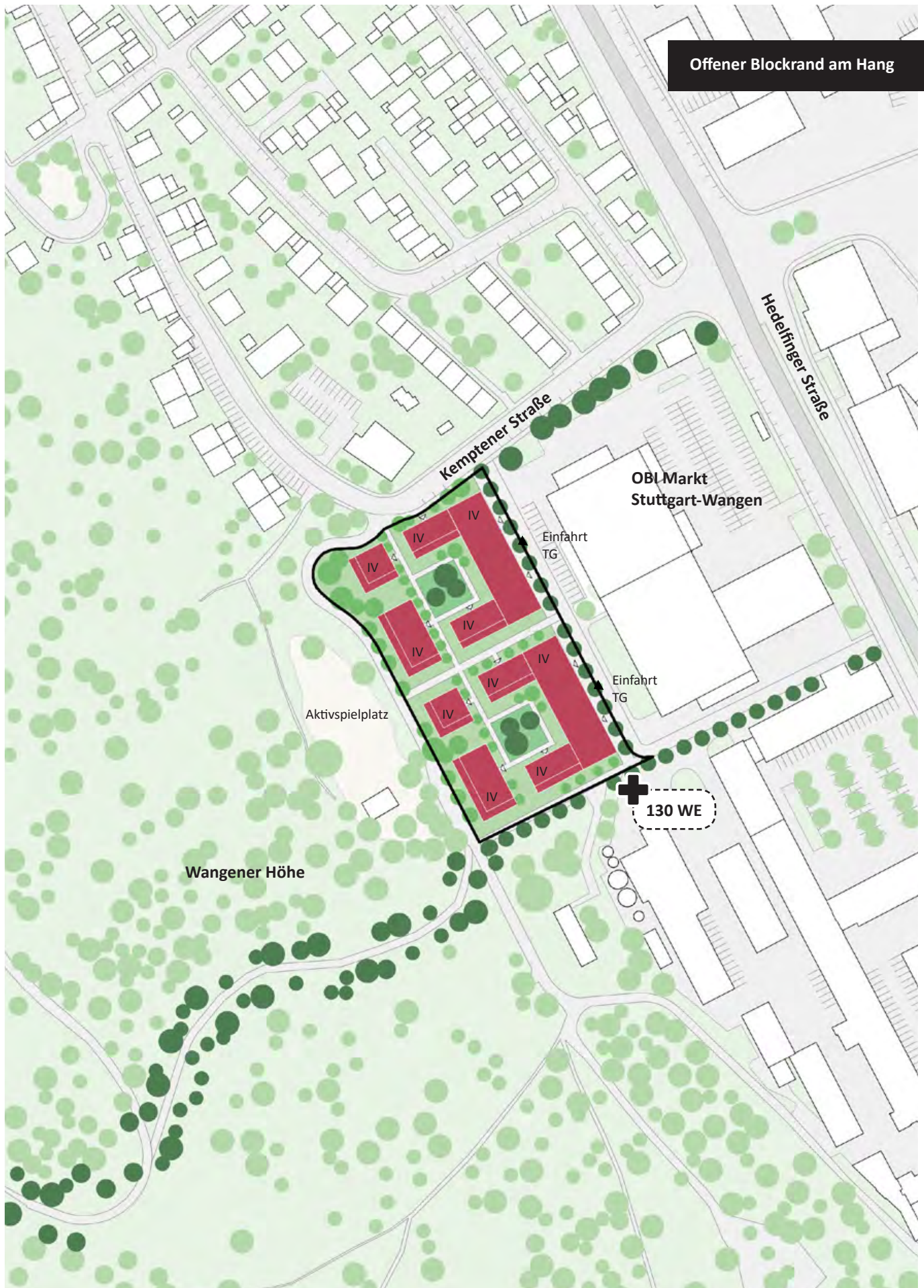
Abb. 61: Lageplan der Bebauungsvariante mit einer offenen Blockrandstruktur
